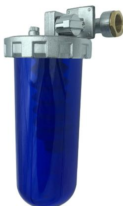
Dosatore proporzionale di polifosfati in ottone, attacchi con ghiera 1" (con riduzione 3/4") con valvola di stop + cartuccia maxi di polifosfato. Dosaggio: 3ppm (3mg/L). Pressione max esercizio 5 bar. Temperatura 1-45 C°.
