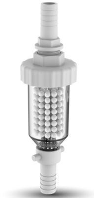
Il filtro neutralizzatore di condensa Ikaro neutralizza in maniera efficace la condensa acida delle caldaie a condensazione, mantenendone il valore di pH entro i limiti consentiti dalle normative vigenti. Attacchi 3/4 M. completo di portagomma IN/OUT dritto e curvo e kit per il fissaggio a muro.
