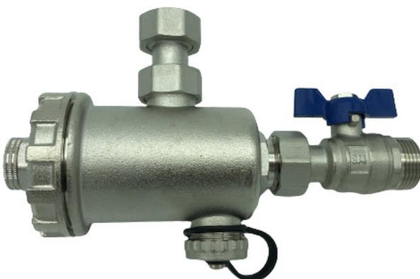
Defangatore magnetico con testata e vaso in ottone nichelato. Ideato per catturare e trattenere le particelle di magnetite e tutte le impurità (ruggine, sabbia). La variazione di sezione frena il flusso dell'acqua permettendo così al magnete di attrarre tutte le impurità di origine ferrosa, mentre le particelle non ferrose vengono filtrate dalla rete inox.
